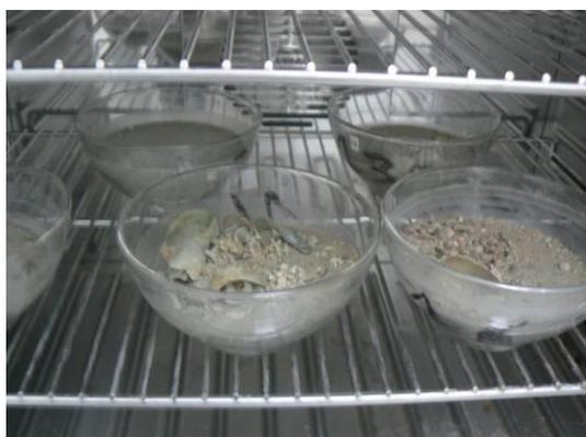
*Figure 4 : Echantillons granulométriques à l'étuve (Cliché TBM)*
